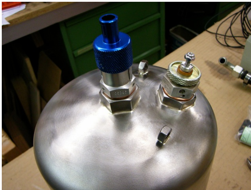
Angelötete Mutter für den Chip Detector und Öl-Schnellablass
