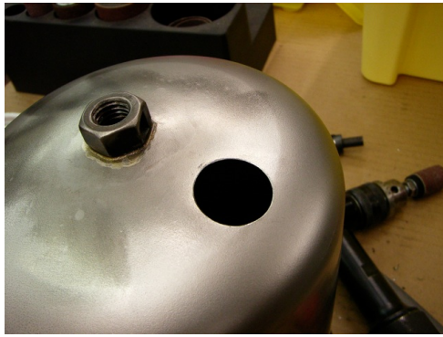
Loch im Ölreservoir für die Mutter vom Chip Detector
