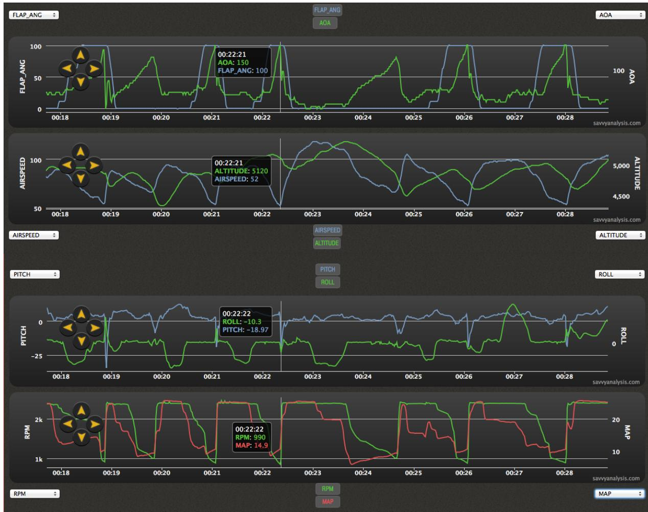
Für den obersten Graph habe ich meine Flap-Position und die Angle of Attack (AOA) Werte gewählt. Damit kann der exakte Zeitpunkt des Strömungsabrisses identifizieren werden. Der darunter liegende Graph zeigt die Höhe in ft und die KIAS (indicated airspeed in kt) an. Der dritte Graph zeigt den Roll- und Nickwinkel in  $^{\circ}$  an.
