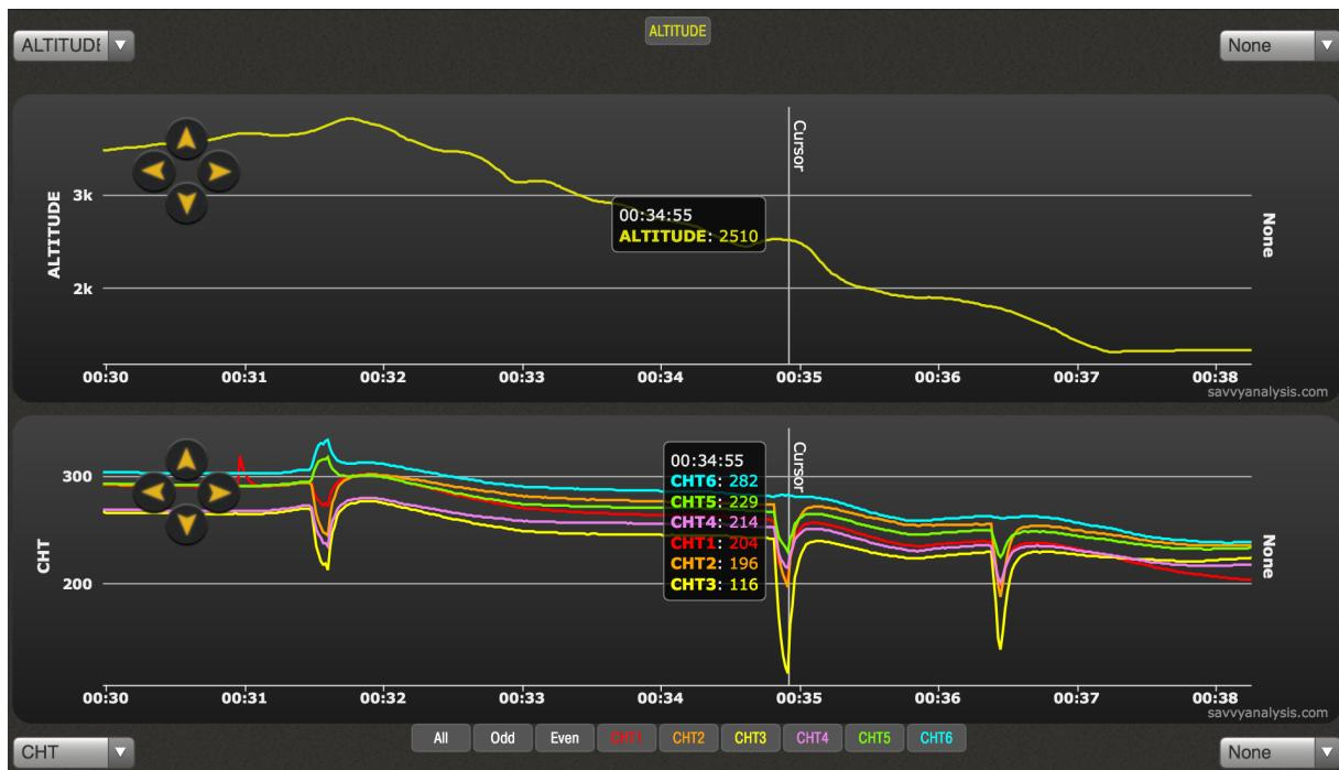
Auflösung: Die Ausschläge treten bei ca. 4000 ft, 2500 ft und 1700 ft auf. Dies entspricht den Höhen bei Sektor West, Overhead und Final und zeigt die abgesetzten Funkmeldepunkte auf COM 2. Physikalisch wäre eine Temperaturabnahme von über 20 Grad Fahrenheit pro Sekunde nicht möglich.
