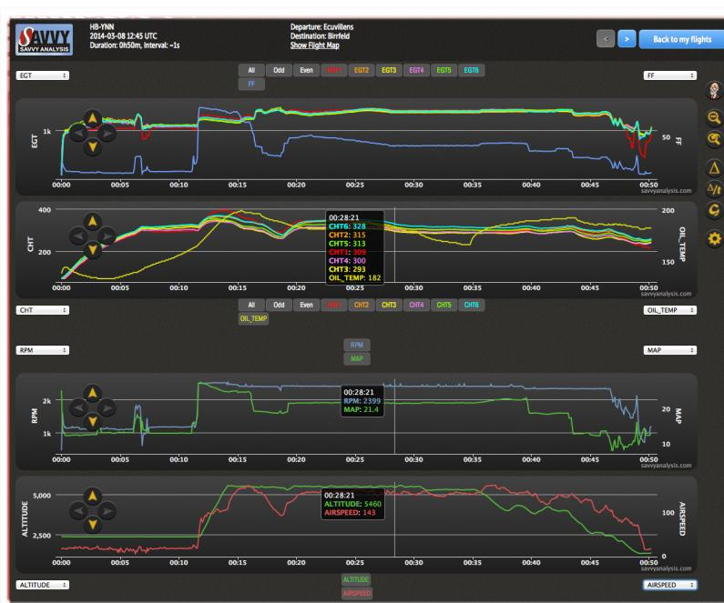
Sehr nützlich ist auch das GAMI-Tool, welches die Spanne des Treibstoffdurchflusses zwischen dem "leanest" und "richest" EGT Spitzenvwert pro Zylinder anzeigt. Dies ist
