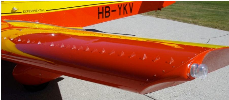
Die Stallspeed ist mit idle Power 8kt tiefer, mit max Power 35kt IAS! Der Strömungsabriss erfolgt viel weniger brüsk, und das Flugzeug bleibt auch im Stall weitgehend kontrollierbar, was bei einer Notlandung im Gelände von sehr grosser Bedeutung ist.
