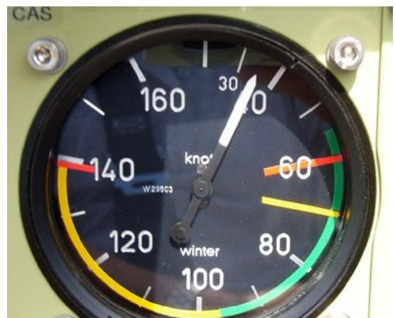
Beim Start kann ich das Bugrad, dank wirksamerem Elevator, früher entlasten. Über 30kt macht der Flügel bereits Auftrieb, womit auf schlechten Pisten das Fahrwerk entlastet wird, und im nassen Gras reduziert sich der Rollwiderstand erheblich.
