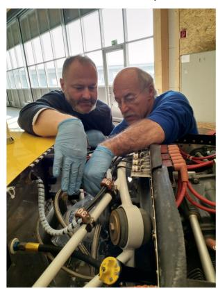
Der Ausbau des Ölfilters ist nicht so einfach ohne eine «Sauerei» zu hinterlassen.
