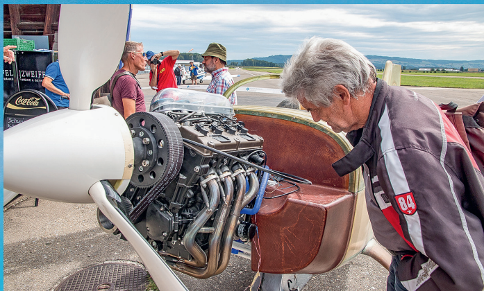
Europa XS von Ralph Zuber im Bau, angetrieben von einem Kawasaki-Motorradtriebwerk. | L'Europa XS de Ralph Zuber encore en construction, propulsé par un moteur de moto Kawasaki.
