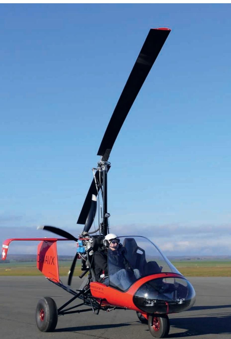
Gyrocopter sind sicher, relativ kostengünstig und machen viel Spass! Konstruktionsbedingt fliegen sie immer in der stabilen Autorotation, was gegen Turbulenzen unempfindlich und einen Strömungsabriss unmöglich macht. Auch deshalb erfreuen sich Gyrocopter immer gröserer Beliebtheit.
