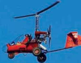
Bestehende Tandem-Gyrocopter sind entsprechend ungeeignet für die Pilotenausbildung. «Im Nacken sitzen» ist nicht nur unangenehm, sondern kann auch gefährlich sein. Deshalb ermöglicht der heavy-duty Gyrocopter mit «side-by-side» sichere Kommunikation, effizientes Instruieren und ein gemeinsames Flug-erlebnis.
