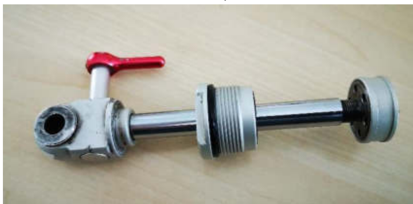
Kolbenstange mit Kolben demontiert (Teile A + D aus der Prinzipskizze) – das Teil mit dem Gewinde in der Mitte ist der Deckel des Kolbens.
