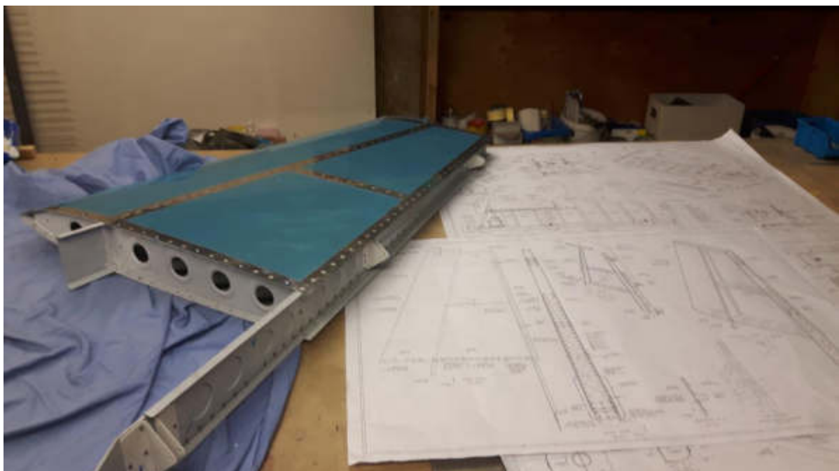
03.02.2019: das Höhenleitwerk und das Seitenleitwerk sind fertig
