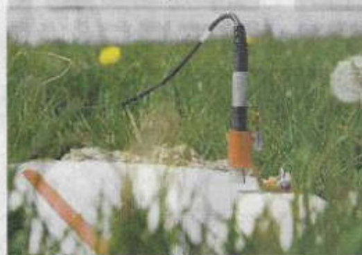
Das Mikrophon misst den Lärm vom Boden aus.
