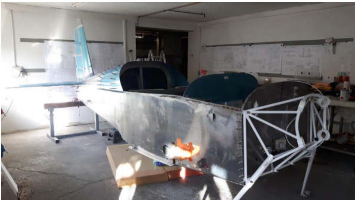
28.09.2019: Anbau und Ausrichtung des Leitwerks auf dem Rumpf und provisorischer Anbau des Motorträgers.
