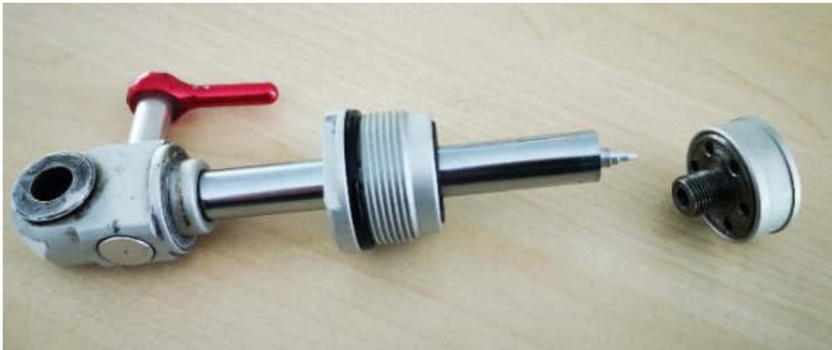
Kolbenstange mit gelöstem Kolben (D)
