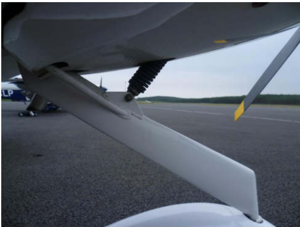
Feder / Dämpfer System der Pulsar
