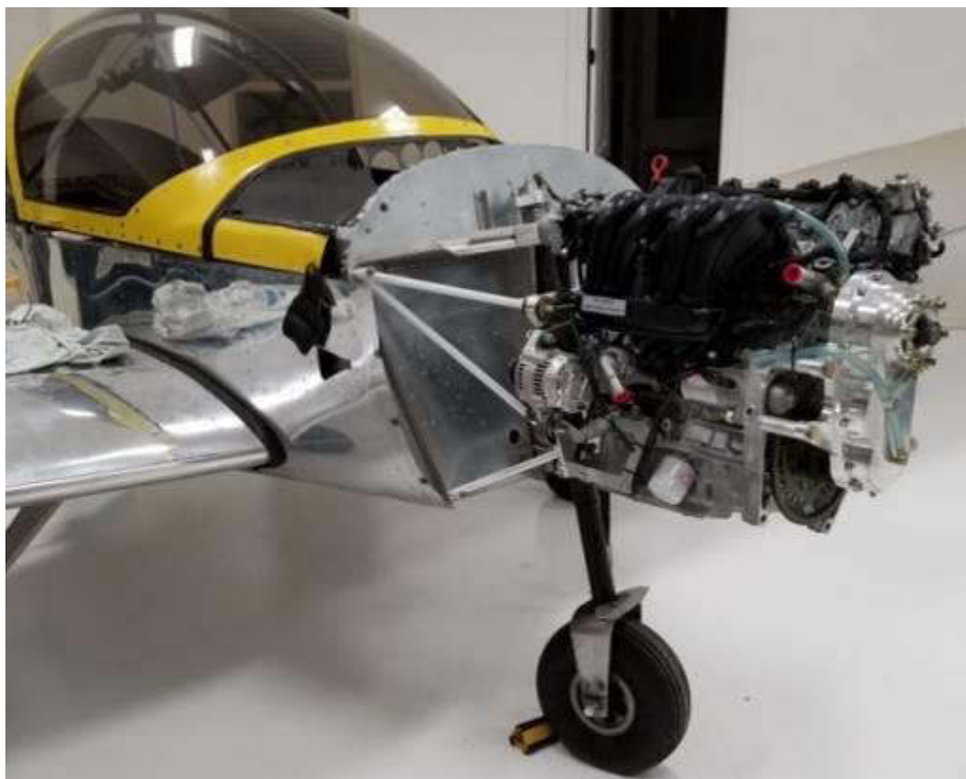
Umbau einer fliegenden Zodiac 601 von Convair auf Viking 130
