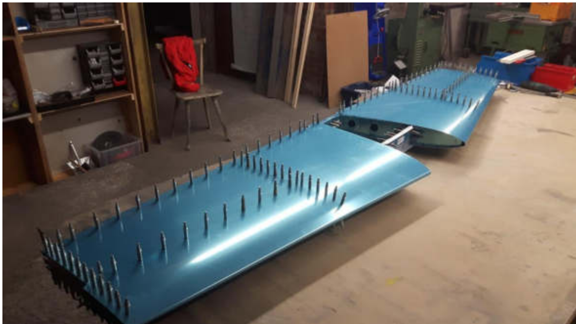
19.01.2019: Der Bau begann mit dem Höhenleitwerk
