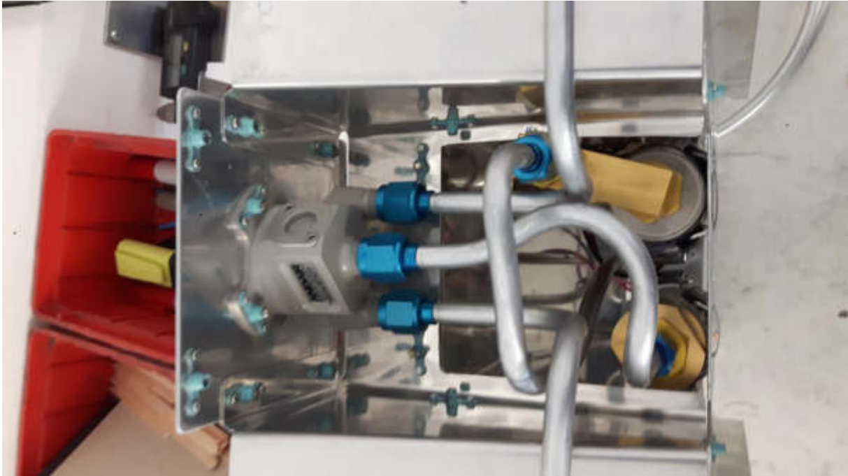
19.09.2019: Einbau der Benzinleitungen, des Benzinfilters und der Hochdruckbenzinpumpe
