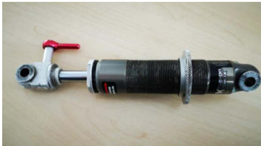
Bei der Pulsar verbauter Dämpfer mit entfernter Feder
