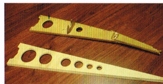
Gebrochen Nach dem Crash war nur noch eine einzige Flügelrippe intakt. Allein die Instandsetzung des oberen Flügels hat zwei Jahre gedauert
