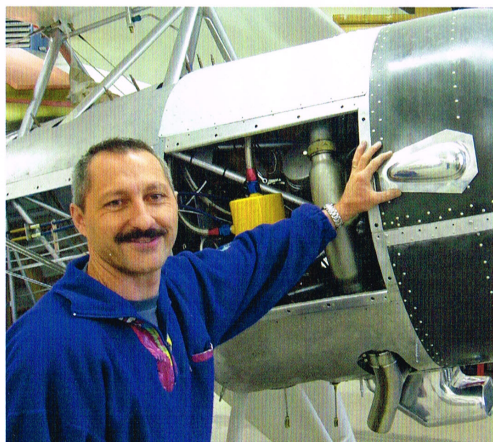
Tüftler Erbauer Andreas Rombach hat zahlreiche Modifikationen vorgenommen. Zu den liebevoll gefertigten Details gehören die von Hand gehämmerten Alu-Hutzen über den Ventildeckeln
