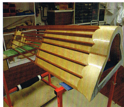
Vom Feinsten Das neue Turtleneck hinterm Piloten. Der vordere Teil der Holzkonstruktion dient als Gepäckfach
