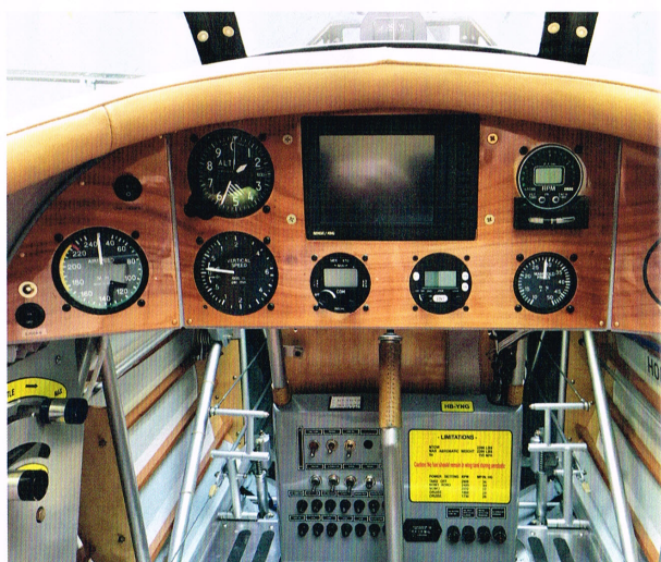
Runde Sache Funk und Transponder (Mitte) passen zu den klassischen »Uhren«. Neben den Schaltern und Sicherungen sind Betriebsgrenzen und Power Settings aufgelistet
