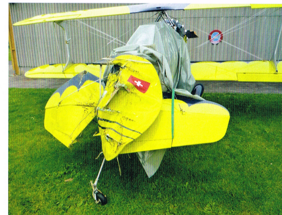
Totalschaden Nach Triebwerksstillstand während der Flugerprobung hatte sich der Taildragger bei der Notlandung überschlagen. Zu den irreparablen Schäden gehörte das Leitwerk
