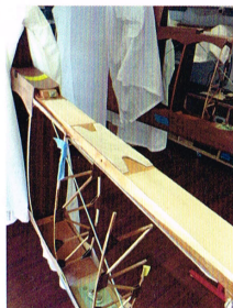
Eingeschäftet In beide Holme der oberen Tragfläche mussten vier 0,7 Meter lange Stücke eingesetzt werden (helles Holz)
