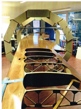
Cleverer Idee Um die durchgehende obere Fläche beim Arbeiten drehen zu können, hat sie Matthias Glutz in zwei große eckige Hilfsräder montiert
