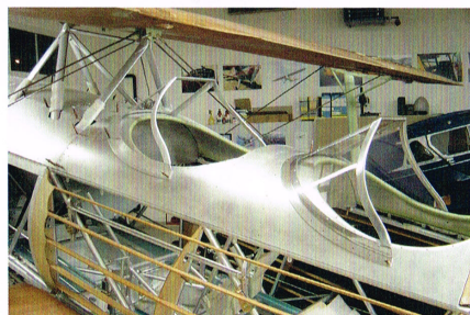
Spenglerarbeit Die geschwungenen Rahmen der Windschutzscheiben hat der Erbauer nach eigenen Vorstellungen gestaltet
