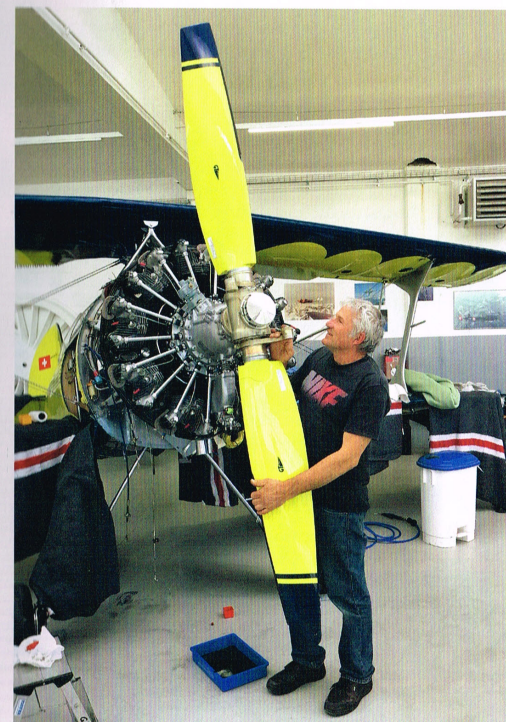
Riesig Die Blätter des Constant-Speed-Props ergeben 2,6 Meter Durchmesser. M-14P-Spezialist Peter Gafner hat sich um den Einbau des Motors gekümmert
