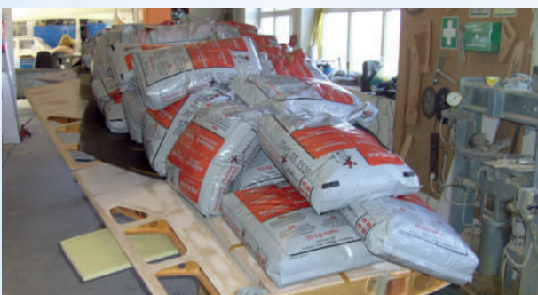
Belastungstest des Flügels
