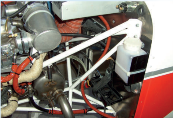
Airbox mit integrierter Vergaservorwärmung
