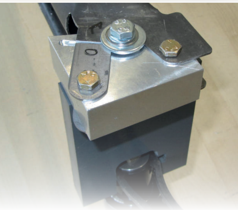
Kupplungsträger mit Vorrichtungen fertig zum Verschweißen
