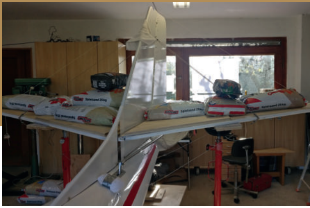
Erfolgreicher Belastungstest des Höhenleitwerks
