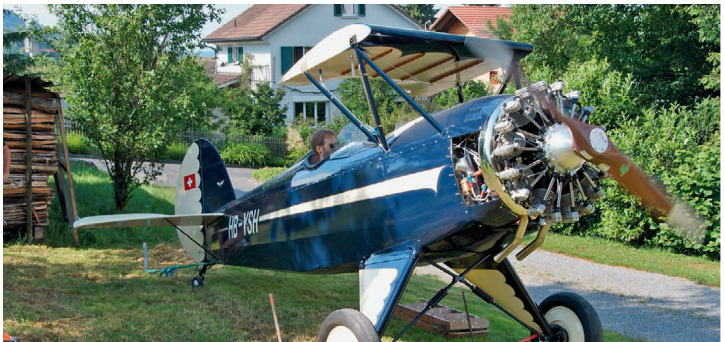
Nach dem Erhalt unseres MT-Propellers konnte der erste Motorenlauf im Mai 2013 erfolgen. Der Sternmotor hat nun schon etwa 3 Std. Standlaufzeit und läuft ausgezeichnet. Weitere Tests wie Standschubmessung, Rollversuche usw. erfolgen dann diesen Frühling auf dem Flugplatz.
