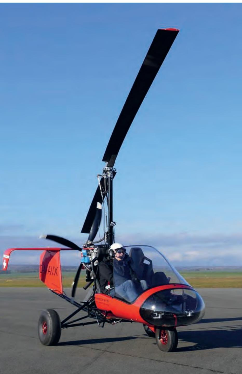
Gyrocopter sind sicher, relativ kostengünstig und machen viel Spass! Konstruktionsbedingt fliegen sie immer in der stabilen Autorotation, was gegen Turbulenzen unempfindlich und einen Strömungsabriss unmöglich macht. Auch deshalb erfreuen sich Gyrocopter immer gröserer Beliebtheit.
