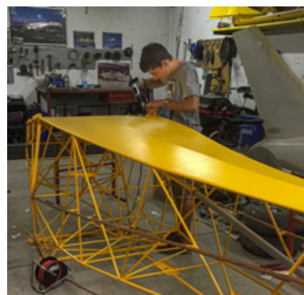
Trempage de la face inférieure du fuselage
