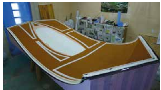
Das Mittelteil hat Aramidwaben-Kerne, für die weiteren Bauteile schwenken wir auf PVC-Schaum um.
