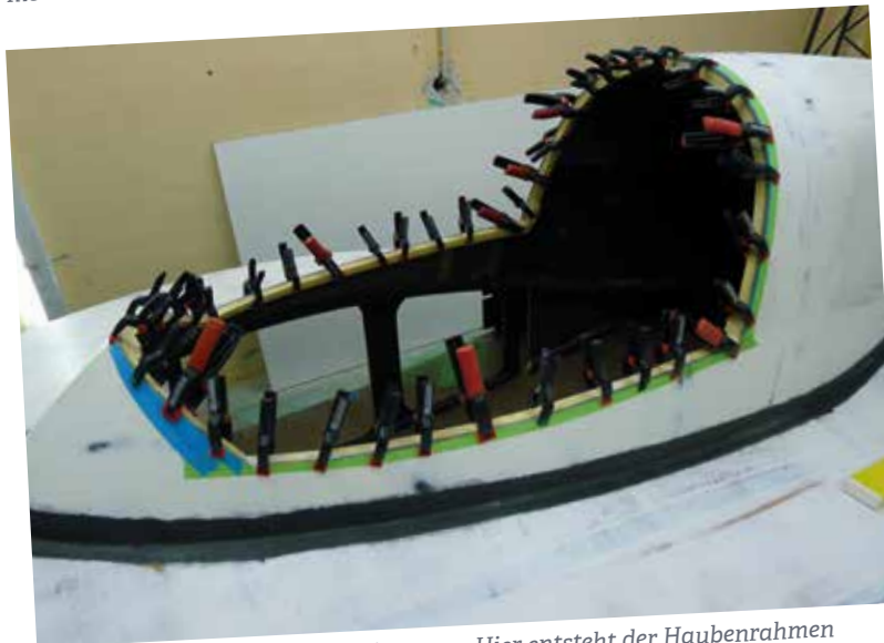
Von den Klammern hat man nie genug. Hier entsteht der Haubenrahmen
