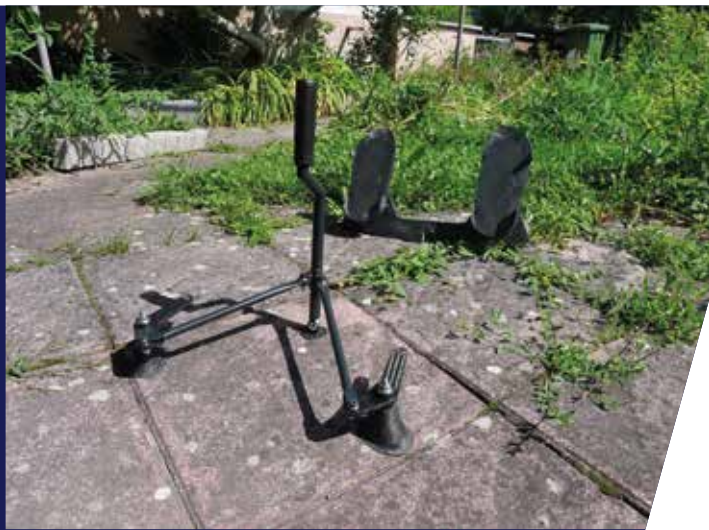
Der Elevon-Mischer ist eine Besonderheit von Nurflügeln. Die Pedale werden nur zum Rollen am Boden und für die Betätigung der Widerstandsseitenruder benötigt.
