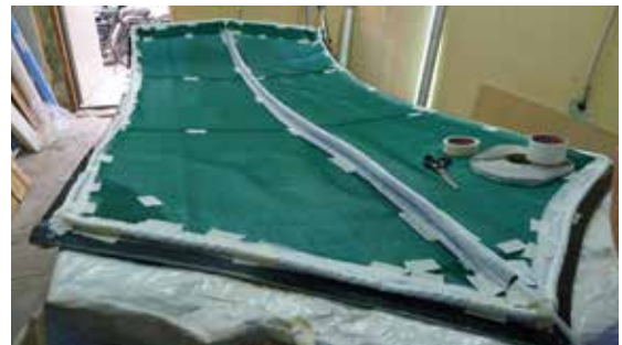
Bei 3 qm ist das Vakuuminfusionsverfahren gegenüber nass-in-nass deutlich von Vorteil.
