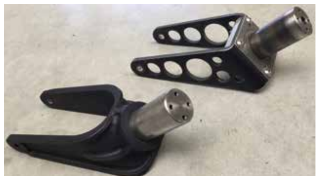
Heckrad 2.0 FE-optimiert, aus dem Vollen gefräst und leichter
