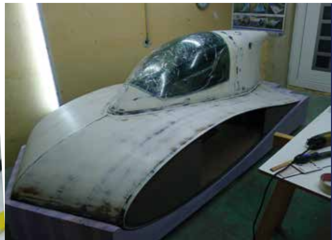
Schneewittchen mit Haube. Rahmen und Haube werden noch mit Sikaflex® 295 UV verklebt.
