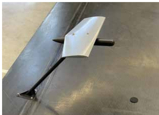
Ausgleichsgewicht mit aerodynamischer Hilfe, dem Spade
