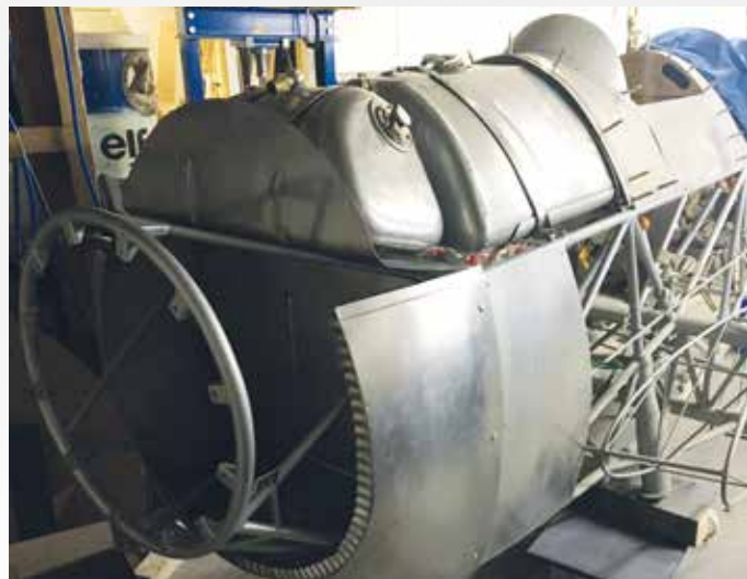
Aufwendige Blecharbeiten im vorderen Rumpfbereich 2019
