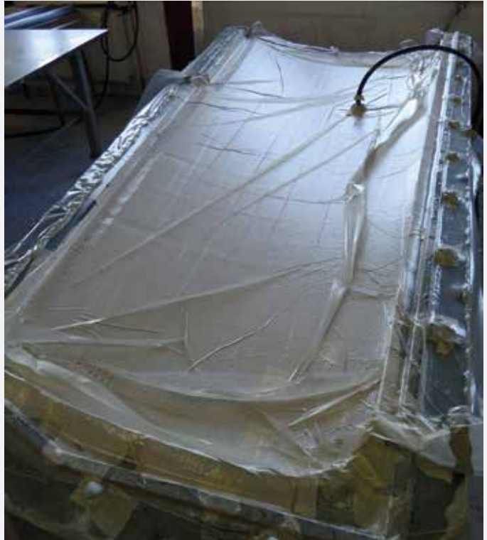
Die Flügelschale wird abgesaugt
