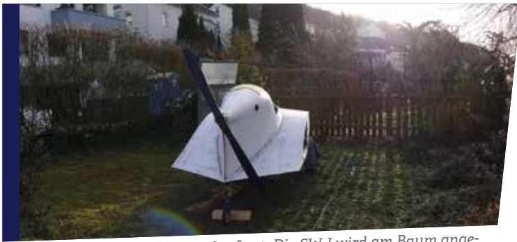
Vorbereitung für den Motorlauftest: Die SW-I wird am Baum angebunden. Der Faltpropeller soll später den Segelflug erleichtern.
