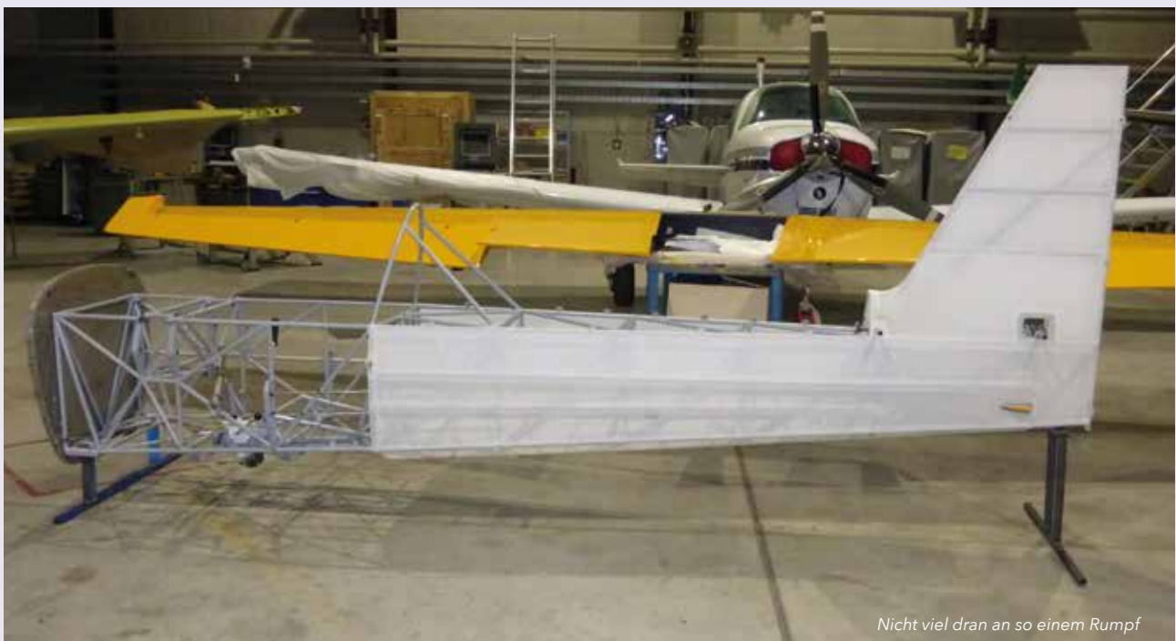
Vorbereitungen zum Belastungstest
