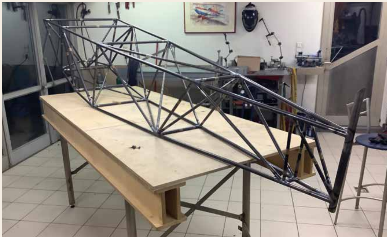
Lasergeschnittene Rohre und das fertige Rumpfgerüst auf dem Bautisch
