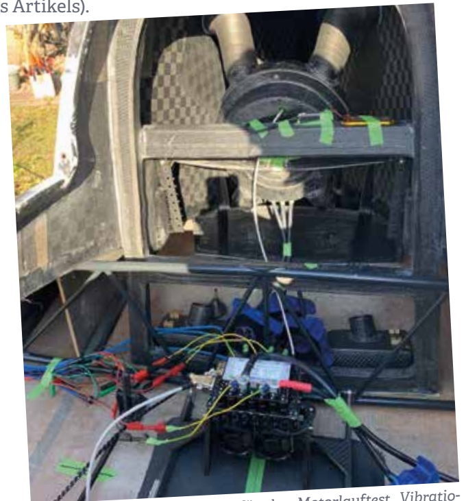
Verkabelung der Messtechnik für den Motorlauftest. Vibrationen und Leistungen werden dabei mit hoher Abtastung erfasst und in Echtzeit ausgewertet.
