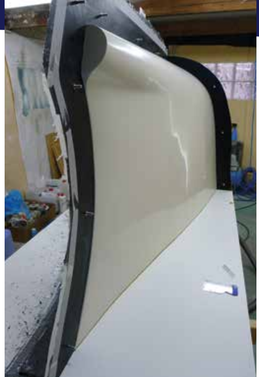
Die Negativ-Form der Kabine ist dreiteilig.
