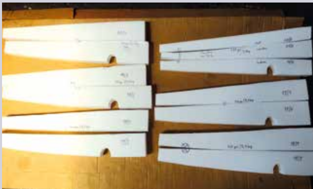
Schaumstoffrippen als Schwimmhilfe
