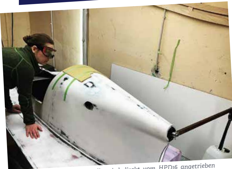
Die ein Meter lange CFK-Welle wird direkt vom HPD16 angetrieben und muss eine sichere Last von 1,25 x 80 Nm standhalten. Tragen einer Schutzbrille während des Belastungstests ist daher selbstverständlich.
