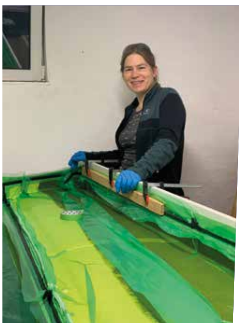
Maja überwacht die Harzinfusion und freut sich über die gelungene Vorarbeiten.
