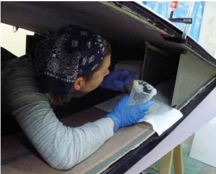
Bis in die hintersten Ecken müssen die Rippenverklebungen verstärkt und überschüssiges Harz entfernt werden.
