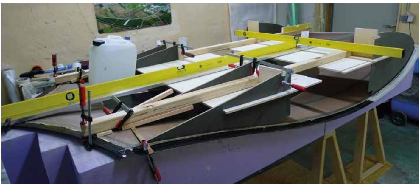
Die gefrästen CFK-Sandwich-Rippen werden für die Hochzeit von Ober- und Unterseite der Schale mit einer Schablone ausgerichtet und eingearbeitet.
