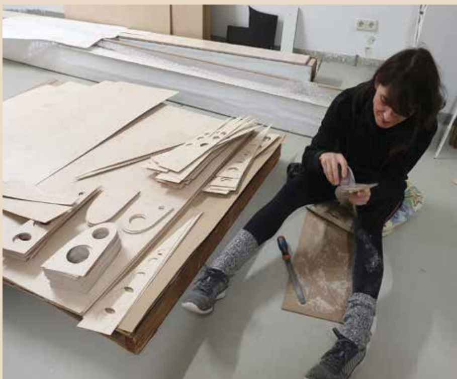
Bau der Rippen aus Sperrholz und Kiefernleisten
