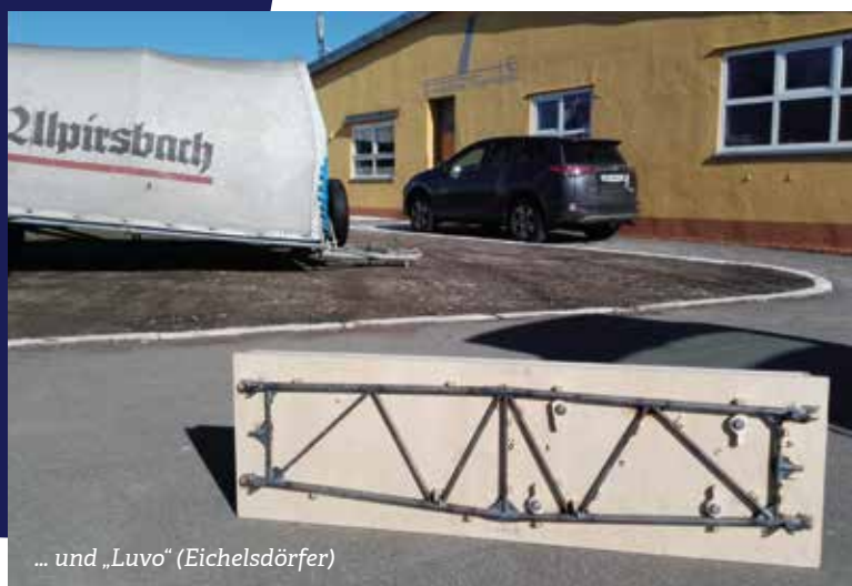
Die Holmbrücken werden geschweißt: bei Roman Weller ...
