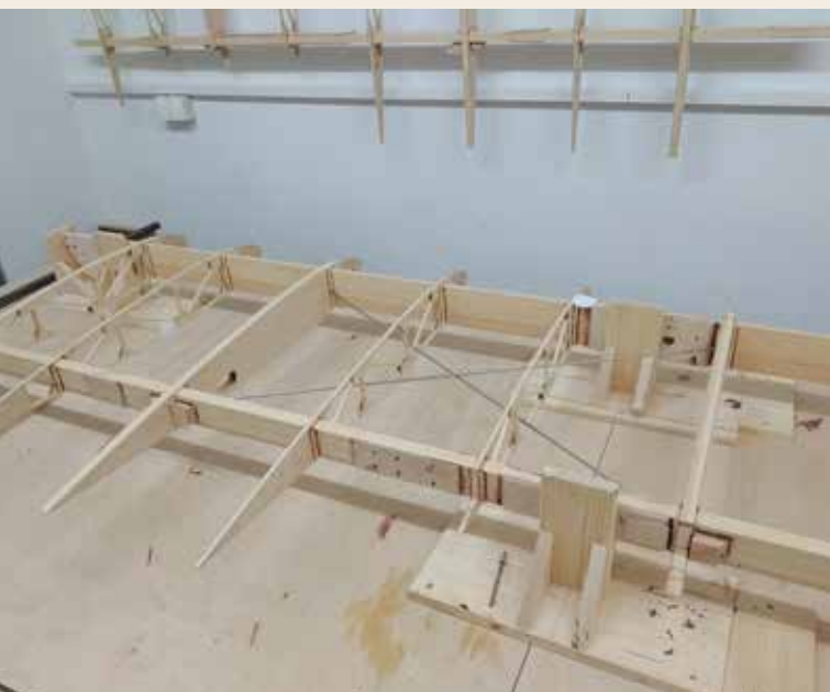
Verbohren der Spanndrähte und rohbaufertige Tragflächen
