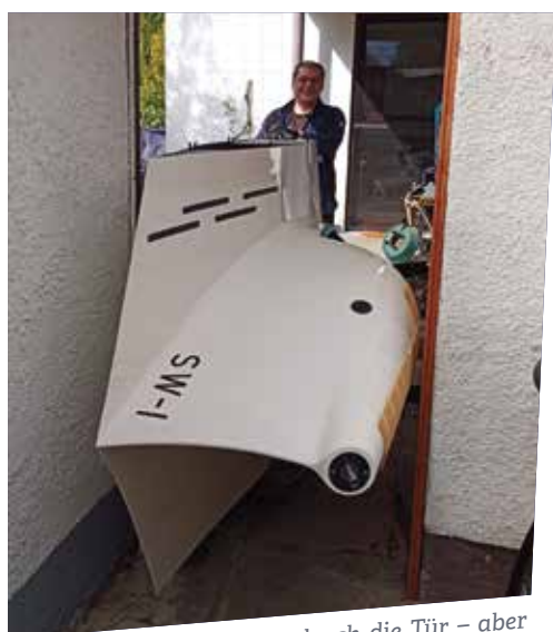
Die SW-I passt gerade so durch die Tür – aber nur ohne Fahrwerk. Wer selbst entwickelt und ohne fremde Vorgaben baut, hat zwar mehr Arbeit, aber auch gewisse Freiheiten.
