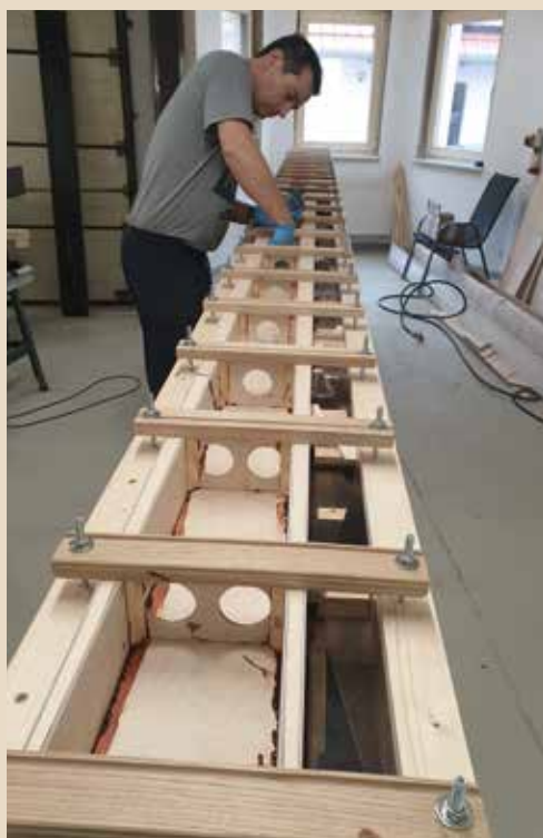
Bau der Flügelholme
