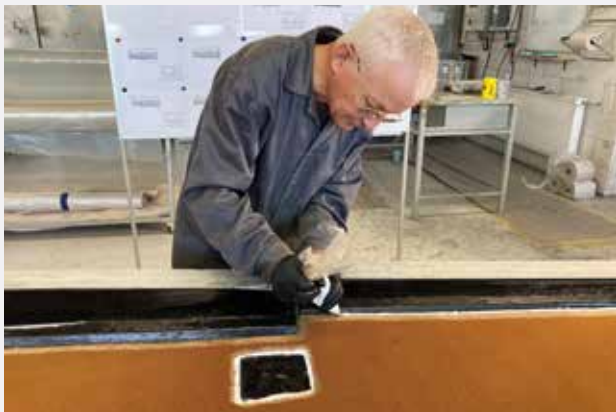
Einlaminieren der dünnen Wabenplatte als Stützstoff
