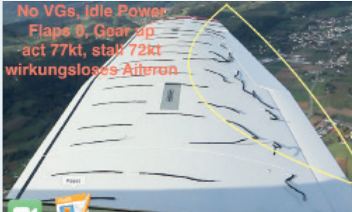
Langsamflug ohne Vortexgeneratoren: Keine Anströmung des Querruders. | Vol lent sans générateurs de tourbillons: aucun écoulement de l'aileron.
