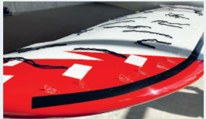
Flügel mit Wollfäden und aufgeklebten Vortexgeneratoren. | Ailes avec fils de laine et générateurs de tourbillons collés.
