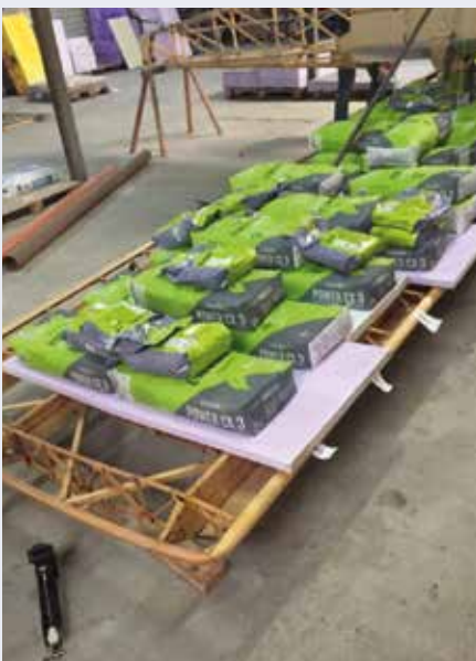
Belastungsversuche Tragflügel und Seitenruder
