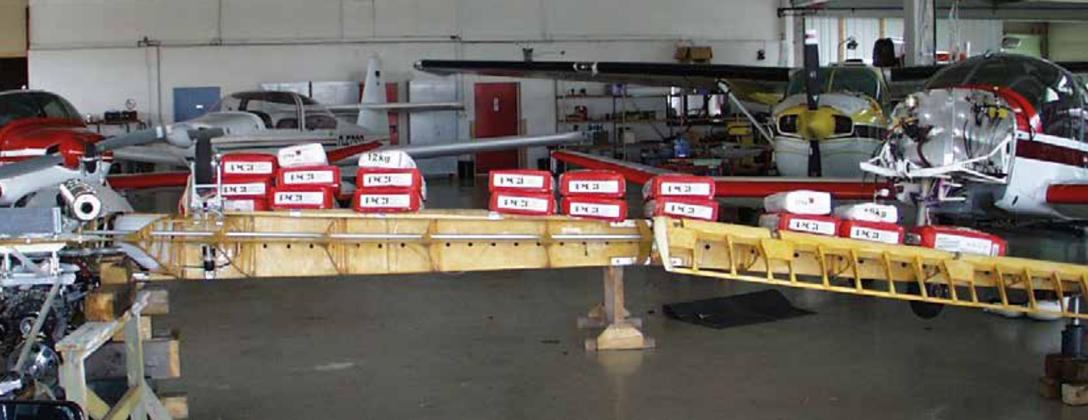
Belastungsversuch des Tragflügels
