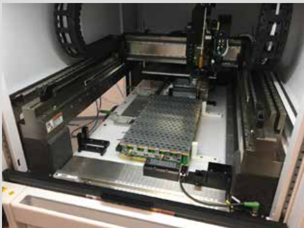
Die Akku-Zellen werden maschinell auf die Stromschiene „gebondet“
