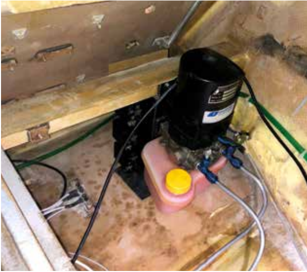
Neue Position der Fahrwerks-Hydraulikeinheit
