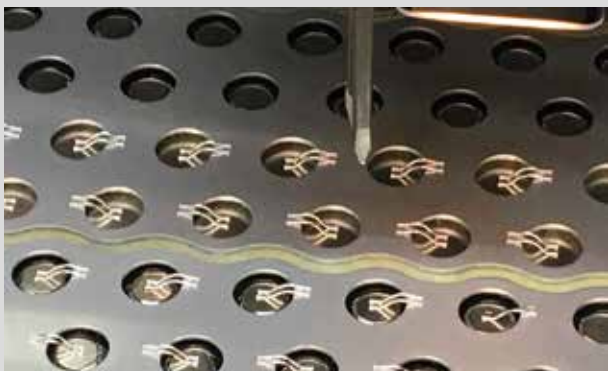
Die Verbindung Zelle und Stromschiene mit Sicherungsdraht
