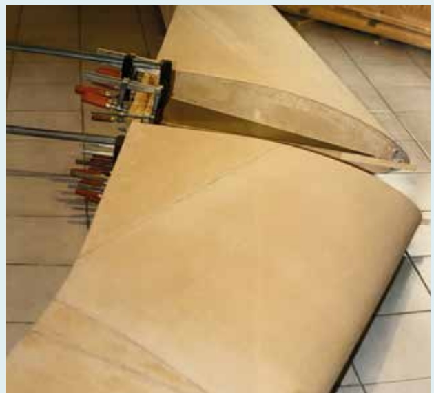
Am Anfang war der Holm, der mit Hilfe von Rippen zu einer Torsionsnase wurde
