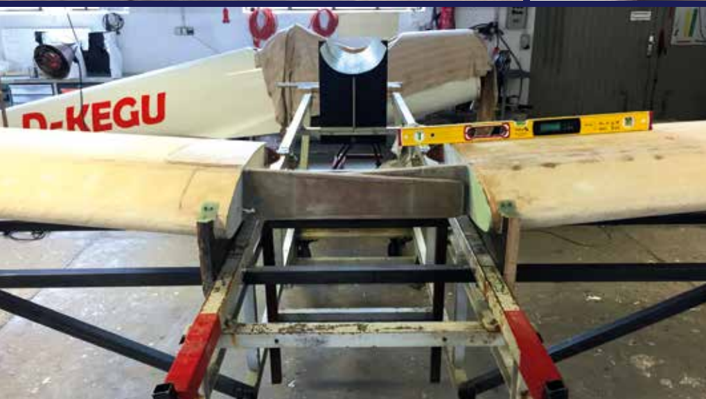
[alle Bilder] kombinierte Rumpf- und Flügelhelling
