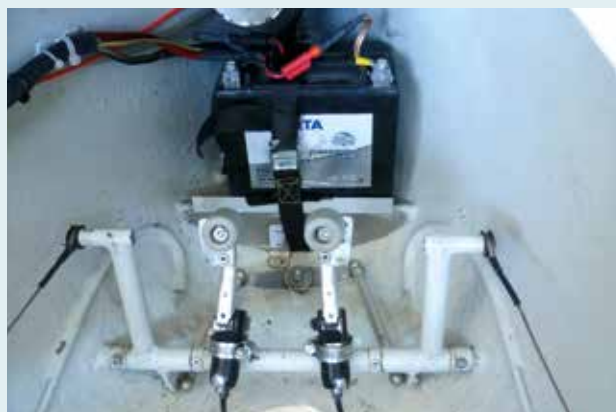
Außen Seitenruder- und innen Bremspedale
