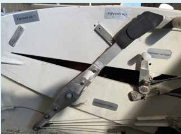
... das Vierbeinfahrwerk wird mechanisch ein- und ausgefahren ...
