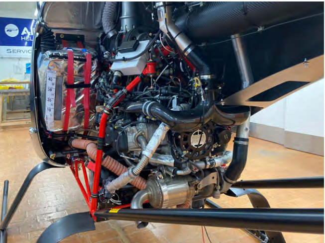
Eingebauter EPA Power SA-R917-Ti mit 130 hp EPA Power SA-R917-Ti de 130 hp intégré
