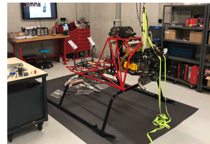
Getriebe und Motor hängen schon mal im Rahmen La boîte de vitesses et le moteur sont déjà suspendus dans le cadre
