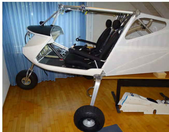
Rumpf rohbaufertig, bereit für den Einbau von Motor und Avionic – Fuselage brut, prêt à recevoir le moteur et l'avionique
