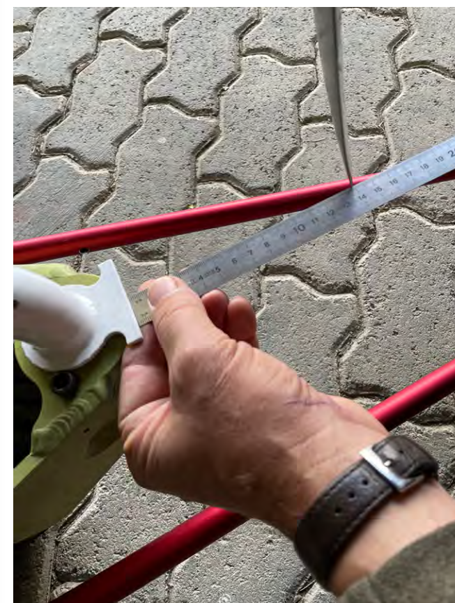
Bestimmen des Hebelarms des Bugfahrwerks für die Schwerpunkt-berechnung – Détermination du bras de levier du train avant pour le calcul du centre de gravité
