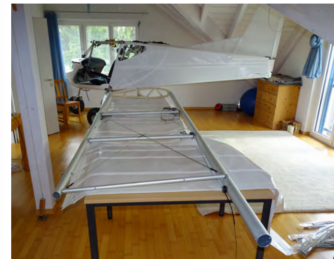
Auch die Flügel werden mit einem fertig genähten Nylonschlauch überzogen – Les ailes sont également recouvertes d'un tube en nylon déjà cousu
