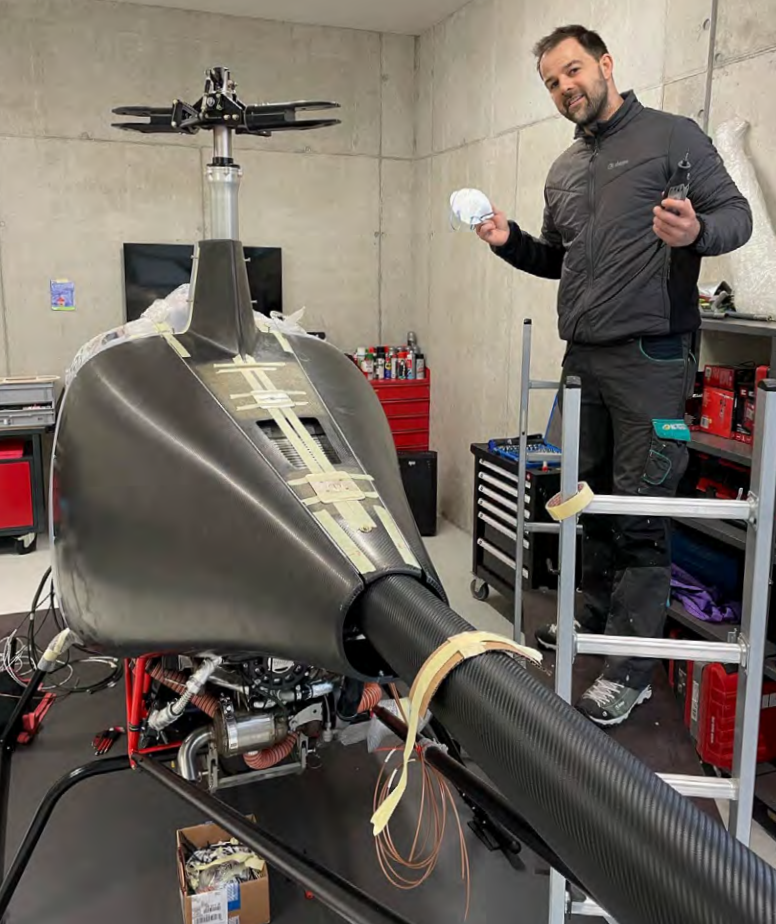
Anpassen der Rumpfverschulung aus Carbon Ajustement de l'habillage de la coque en carbone
