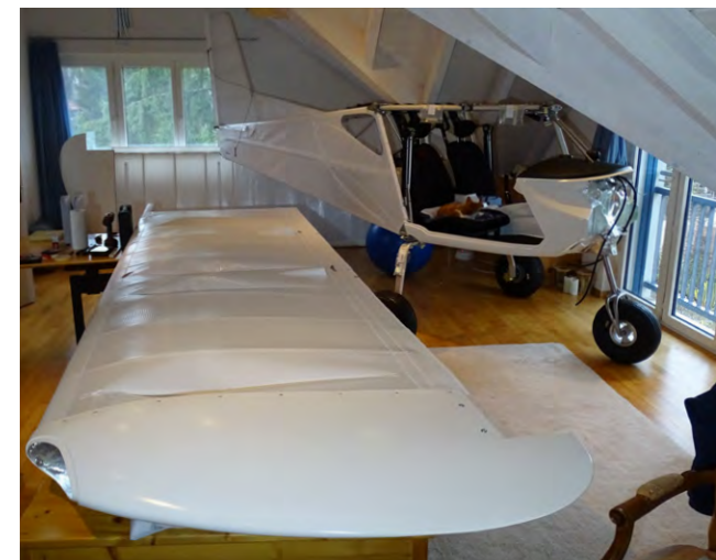
Auch die Flügel werden mit einem fertig genähten Nylonschlauch überzogen – Les ailes sont également recouvertes d'un tube en nylon déjà cousu
