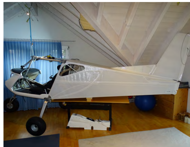
Rumpf rohbaufertig, bereit für den Einbau von Motor und Avionic – Fuselage brut, prêt à recevoir le moteur et l'avionique
