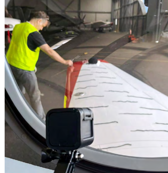
Mit Hilfe einer GoPro wurden die Wollfäden im Flug gefilmt – Les fils de laine ont été filmés en plein vol à l'aide d'une GoPro
