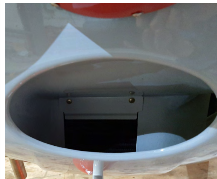
Eingebautes Abdeckblech auf dem Öl-Kühler Tôle de protection intégrée sur le refroidisseur d'huile
