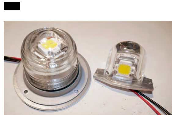
Abb. 6: LED Beacon und Strobelight, fertig eingebaut Image 6 : Beacon LED et strobelight, déjà installées
