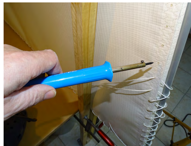
Die Löcher für die Befestigungsschnüre werden mit dem Lötkolben „gebohrt“ Les trous pour les cordons de fixation sont „percés“ avec le fer à souder
