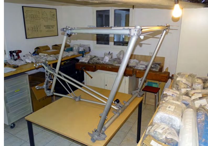
Einfache Bauweise: Die Rohre des Rahmens werden mit Knotenblechen vernietet Une construction simple : Les tubes du cadre sont rivetés avec des goussets
